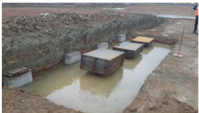
Рис. 4. Широкомасштабные блочные сдвиговые испытания in-situ
