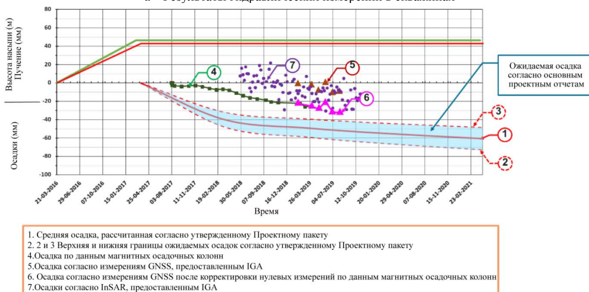
б- Результаты измерений поверхностных осадок во времени со сравнением разных методологий.
