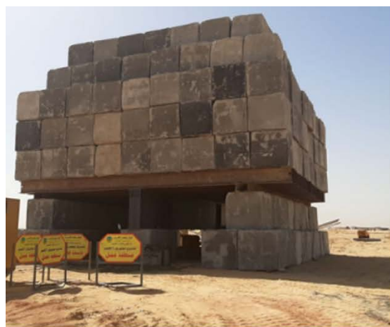
Рис. 17. Работа буронабивных свай большого диаметра в просадочных грунтах
