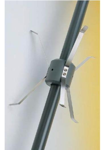
*Голова подвеса экстензометра для ручных измерений*
