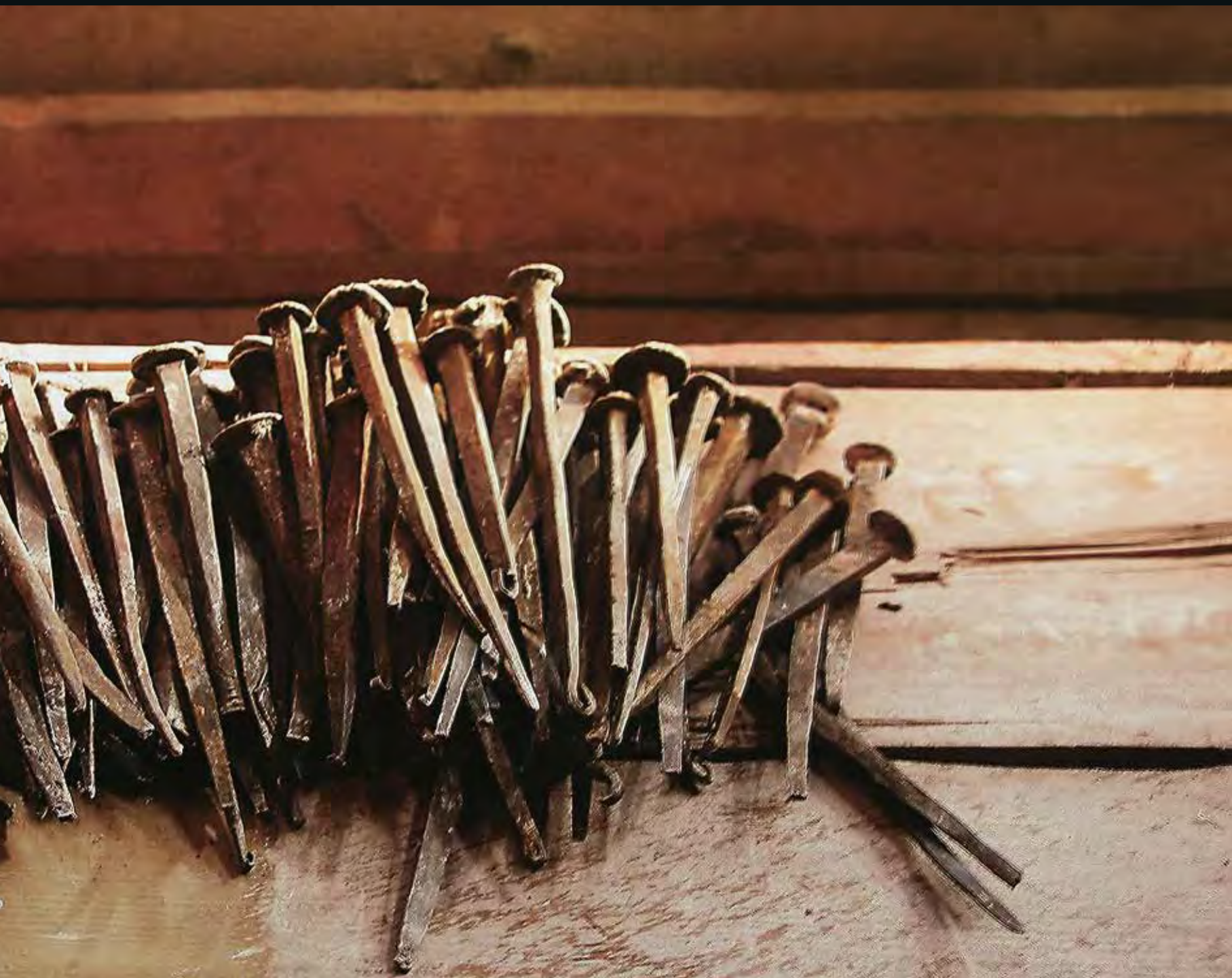
Кованые гвозди, извлеченные при демонтаже деревянной облицовки наружных стен
